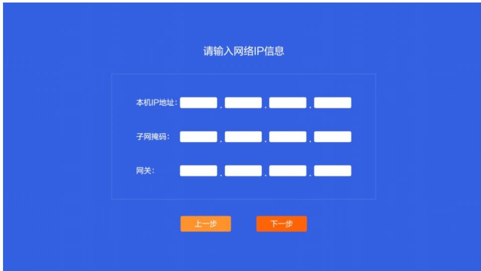
本机IP地址输入192.168.1.168，子网掩码输入255.255.255.0，网关输入192.168.1.1，点击下一步。
