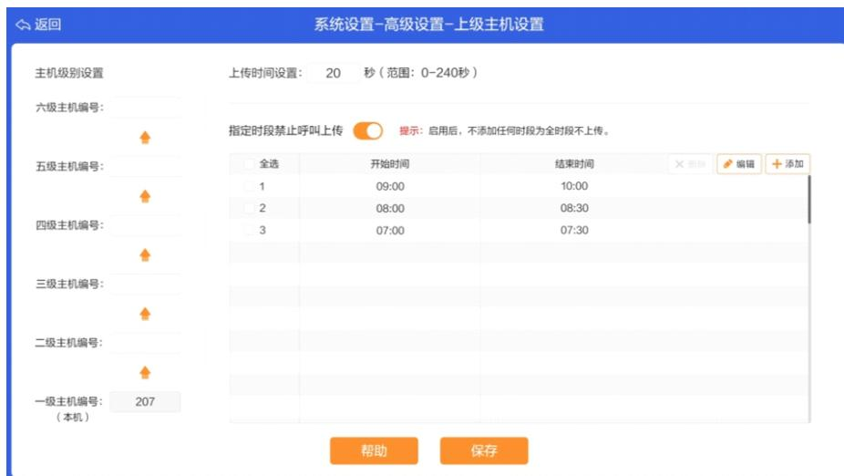
**主机级别设置：**待设的主机编号需为10000路或99Q主机编号，如放置在护士长办公室的10000路主机，构成级别关系来防止护士站主机的无人应答。
