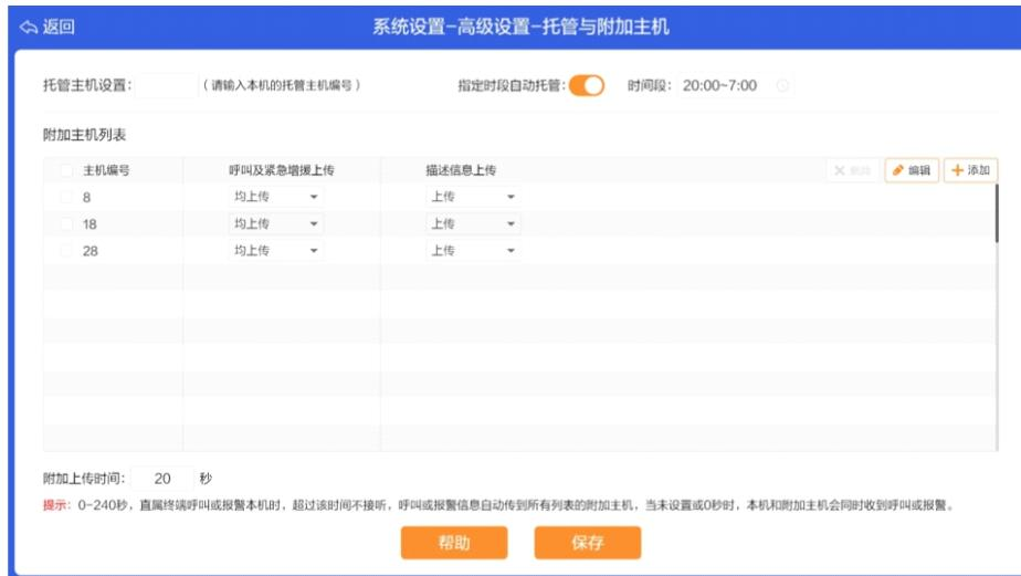
**托管主机设置：**主要用于A护士站主机无人值守时把呼叫事件托管给B护士站主机处理，设置后，可在床位一览界面快速打开托管功能。
