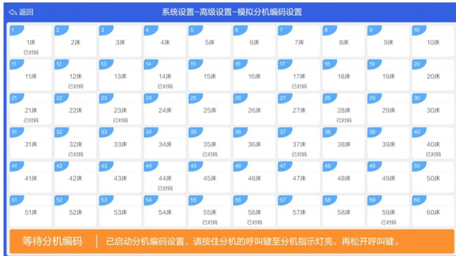
说明：该设置只对模拟分机生效，根据界面提示完成所有模拟分机的编码设置，如需修改可重复编码，系统中不允许有编号相同的模拟分机存在。
